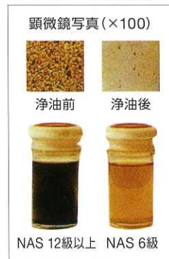
写真② 浄油機SM-4型とマークⅢ・ZSの浄油能力
